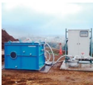
より効率的な深井戸を提供スクリーン部が内管とストレーナーから構成された特殊構造のディープウェル工法です。この特殊スクリーン下部から流入した地下水は、内管の内側に作用している負圧によって空気を混入することがありません。
