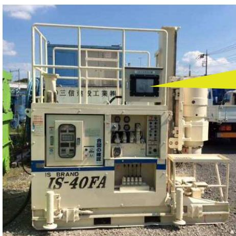
回転制御装置により、大径部と小径部の角度と回転数の制御を行い、多扇形の改良体を造成する。
