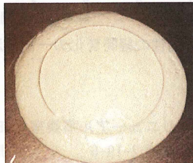
振動・加圧により流動 (15回振動後)
